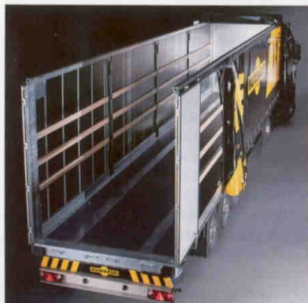
Návěs má klanice vpředu i vzadu sešroubované, na každé straně jsou stavěcí klanice a dvě přídatná lůžka pro jejich umístění
