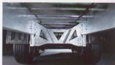
Žárově zinkovaný nosný rám má vysokou torzní tuhost a torzní vzpěry a je vyroben z vysoce pevné oceli
