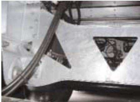
Der aufwändig konstruierte Querträger steift den 6460 Kilo schweren „Big One“ im Bereich des Fahrwerks zusätzlich aus
