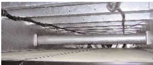
Steif: Zusätzliches Rohr zwischen den Längsträgern
